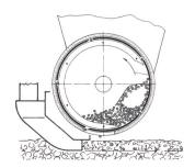
Abb. 1: Mechanisches Korneinzelungsorgan – Innenbelüftung
