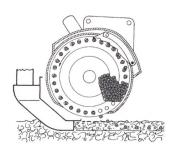
Abb. 2: Pneumatisches Korneinzelungsorgan - Saugluftprinzip
