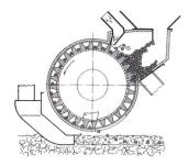
Abb. 3: Pneumatisches Korneinzelungsorgan - Druckluftprinzip
