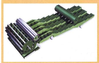
Um die Korn-Stroh-Trennleistung zu erhöhen, wurde beim John Deere WTS im hinteren Bereich der Strohschüttler eine Trommel mit 410 mm Durchmesser und gesteuerten Zinken (Power Separator) eingebaut, welche das kompakte Stroh auflockern soll.
