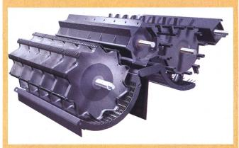
Beim New-Holland-CX-Mähdrescher wurde die Dreschtrommel auf 750 mm, die Wendetrommel auf 475 mm sowie der Zentrifugalabscheider auf 720 mm Durchmesser erhöht. Die Zwangsabscheidefläche wurde gegenüber der TX-Reihe um ca. 12 Prozent erhöht, was sich hauptsächlich in feuchten Bedingungen positiv auswirken soll.
