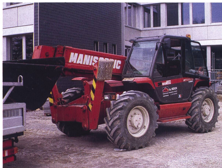
Dieser schwere Teleskopklader eines Gewerbebetriebs übersteigt bauartbedingt den vorderen Überhang (gewerblich: 3 m, landwirtschaftlich: 4 m) und wird zum Ausnahmefahrzeug mit braunem Kontrollschild.
