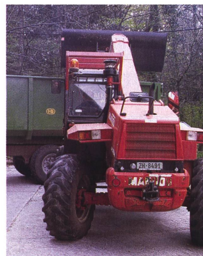
Geprüfte Kabine, eingetragene Anhängelast, durchgehende Anhängerbremse: Dieser Teleskopklader ist als landwirtschaftlicher Motorkarren eingelöst.
