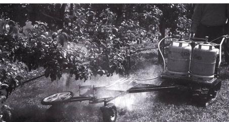
Abb. 6: Die rein thermische Unkrautregulierung ist mit relativ hohem Propangasverbrauch verbunden. Links/rechts: Abflammgerät am Traktor bzw. Raupenfahrzeug (oft Entflammgefahr bei Grasbüschel).
