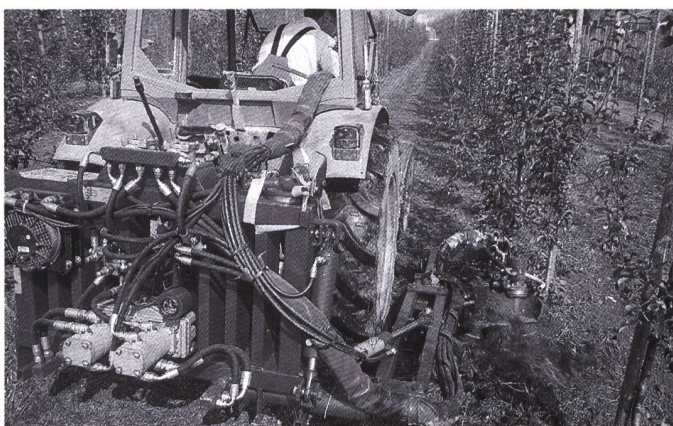
Abb. 1: Für die Unkrautregulierung und Bodenpflege reichen mehrheitlich vier bis fünf Hackdurchgänge aus. Links: Ladurner, mit separatem Ölkreislauf mit Kühlrippentank und Ventilator; rechts: Arbeitseffekt in Baumstreifen mit Humus.
