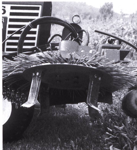
Abb. 2: Ein guter Arbeitseffekt erfordert eine exakte Einstellung der Tastarmsteuerung (Humus). Mitte: Die 15cm-Messer mit Messerkrümmung nach innen sind den 10cm-Messern vorzuziehen (rechts).
