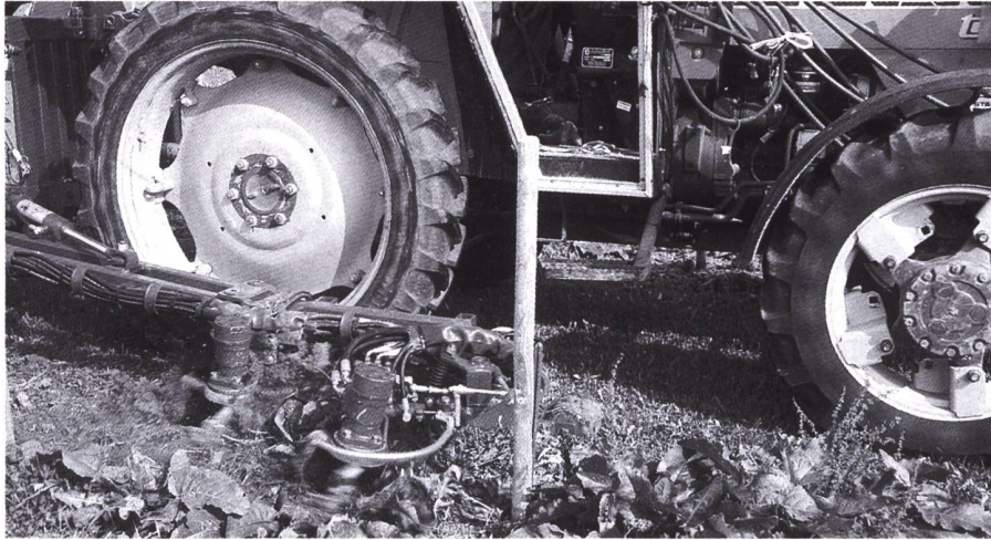
Abb. 1.1: Mit dem Ladurner-Gerät wurde auch im schweren, stark verunkrauteten Boden der beste Arbeitseffekt erzielt.
