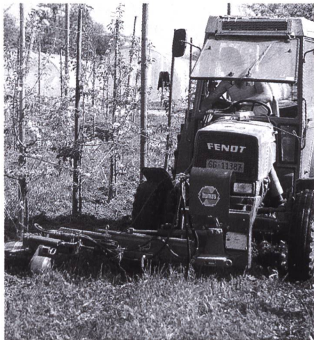
Abb. 2: Ein guter Arbeitseffekt erfordert eine exakte Einstellung der Tastarmsteuerung (Humus). Mitte: Die 15cm-Messer mit Messerkrümmung nach innen sind den 10cm-Messern vorzuziehen (rechts).
