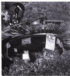
Das Ladurner-Gerät zeichnete sich bei einer Fahrgeschwindigkeit von 2 bis 3,5 km/h durch eine gute Bodenlockerung, -anpassung und Tiefenführung der Hacksätze sowie Einstellmöglichkeiten aus. Auch das Abschneiden der Baumstreifenränder und Ausebnen der Bodenoberfläche fielen recht gut aus.
