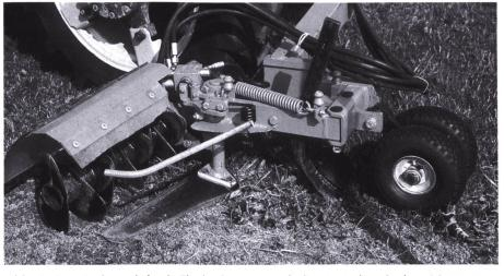
Abb. 3: Der Boden wird mit Flachschar unterschnitten sowie mit dem Messerrotor zerkleinert und eingemulcht (Müller).
