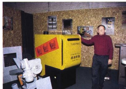
Die Reinigung des Wärmetauschers – bald nicht mehr notwendig – wurde automatisiert, ebenso wie der Schlacken- und Ascheaustrag aus der Feuerungskammer. Die Elektronik erlaubt es, alle Abläufe auf dem Display grafisch und tabellarisch darzustellen. Alle Regulierungsparameter sind in Kombination mit einem Modem auch über die Telefonleitung regulierbar, was Zeit und Geld spart.
