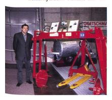
lien. Es ist für den Transport und das Abwickeln von Heu-, Stroh- und Silageballen entwickelt worden. Das Gerät fasst die Rundballen an den Stirnseiten. In angehobener Position können dann Folien und Netz mühelos abgewickelt und entfernt werden. Das Futter oder Stroh wird dann in einem Teppich von 8 bis 20 cm je nach Vorwärtsgeschwindigkeit des Traktor abgelegt. Das Gerät wird an der Dreipunkthydraulik montiert und von einem Hydromotor angetrieben. Götschmann, Maschinenbau, 4802 Strengelbach
