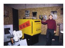
Die Reinigung des Wärmetauschers bald nicht mehr notwendig – wurde automatisiert, ebenso wie der Schlacken- und Ascheaustrag aus der Feuerungskammer. Die Elektronik erlaubt es, alle Abläufe auf dem Display grafisch und tabellarisch darzustellen. Alle Regulierungsparameter sind in Kombination mit einem Modem auch über die Telefonleitung regulierbar, was Zeit und Geld spart.
