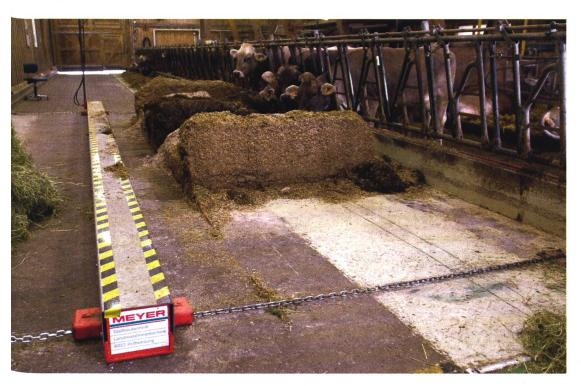
Futtervorschieber bestehen aus einer starren Rahmenkonstruktion von je nach Fabrikat unterschiedlicher Höhe. Über einen Getriebemotor oder ein Hydraulikaggregat betätigte Zugbänder oder -ketten bewegen den Futtervorschieber zwischen Fressgitter und Parkpositon hin und her.
