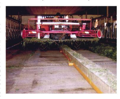
Bei genügender Bodenfreiheit (mindestens 27 cm) wird das Gerät mit Traktor und Ladewagen rittlings überfahren. Schnellkupplungen erlauben die rasche Montage und Demontage der Hydraulikschläuche.
