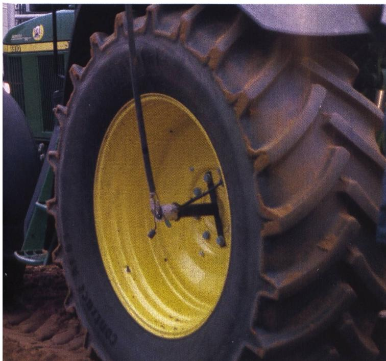
Breitbereifung und die rigorose Druckabsenkung lösen viele, aber nicht alle Probleme der physikalischen Bodenbelastung. Das Bild zeigt die Versuchsanlage an der Agritechnica, die dem Bodenschutz eine breit angelegte Sonderschau widmete.
