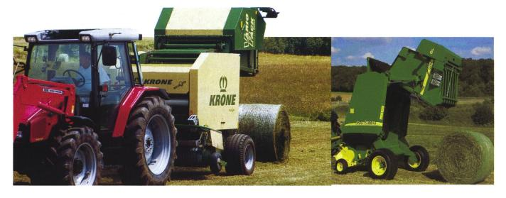
Links: Die Vario Pack 1800 Multi Cut von Krone arbeitet mit Stabketten. Das Schneidwerk hat maximal 17 Messer. Der Ballendurchmesser variiert von 1,0 bis 1,8 m. Rechts: Die John Deere 572, 582, 592 sind die JD-Modelle mit variabler Presskammer. Die Ballen werden mit umlaufenden Bändern geformt. Die möglichen Ballendurchmesser liegen zwischen 0,6 und 1,8 m.
