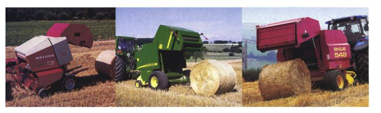
Links: Die Welger RP 220 MASTER Proficut ist eine Konstantkammerpresse mit 18 Presswalzen. Das Schneidwerk kann mit maximal 23 Messern bestückt werden. Mitte: Die John Deere 578 (Nachfolgemodell von 575) ist das JD-Modell mit konstanter Presskammer mit 17 Presswalzen. Der Ballendurchmesser beträgt 1,25 m. Die maximale Messerzahl ist 14. Rechts: Die New Holland 548 Crop Cutter ist eine Festkammerpresse mit Stabketten und mit maximal 15 Messern.
