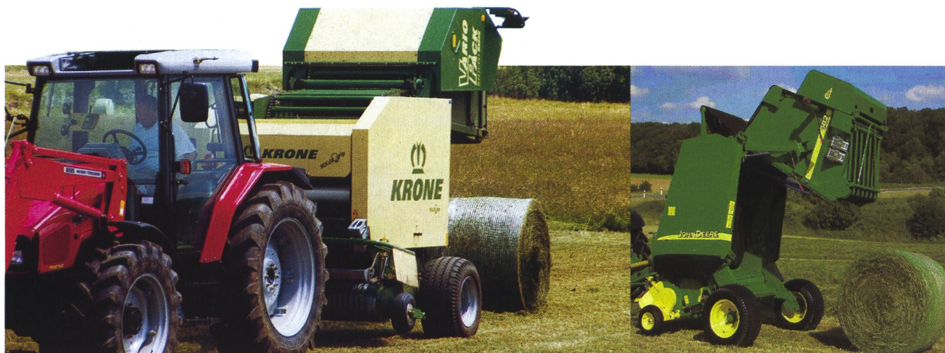
Links: Die Vario Pack 1800 Multi Cut von Krone arbeitet mit Stabketten. Das Schneidwerk hat maximal 17 Messer. Der Ballendurchmesser variiert von 1,0 bis 1,8 m. Rechts: Die John Deere 572, 582, 592 sind die JD-Modelle mit variabler Presskammer. Die Ballen werden mit umlaufenden Bändern geformt. Die möglichen Ballendurchmesser liegen zwischen 0,6 und 1,8 m.
