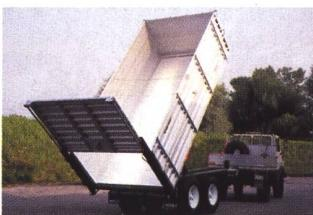
Durch den Einbau der neu entwickelten hydraulischen Heckwand geht ein lang gehegter Wunsch der Marolf-Kundschaft in Erfüllung.
