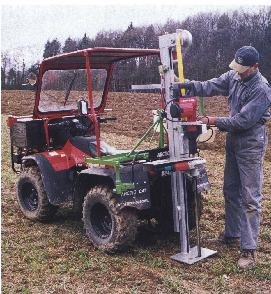
Der Aufbau für den Einsatz für das Stechen von Proben bis zu einem Meter Tiefe ist am Leichtfahrzeug angebaut.
