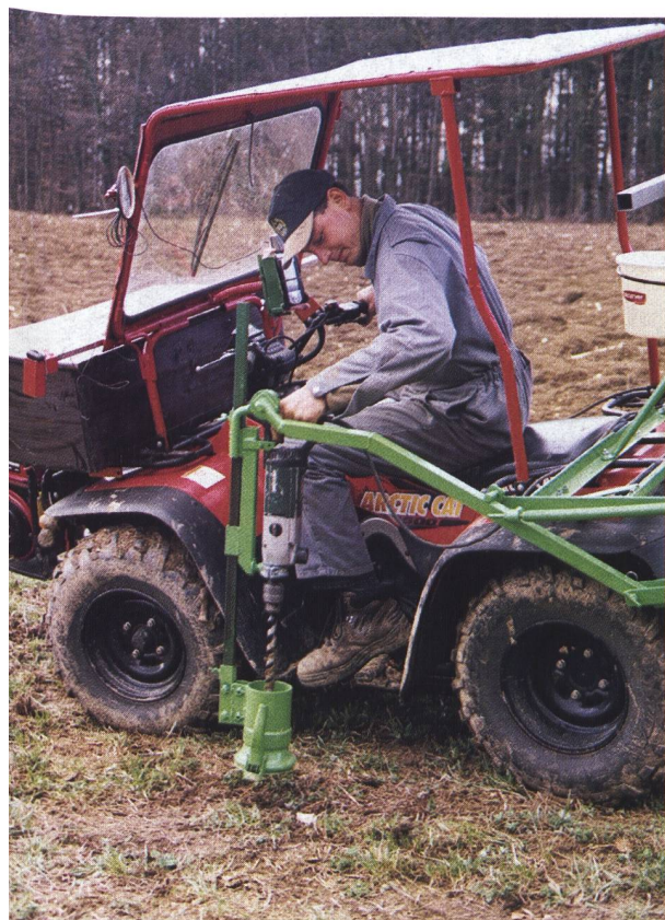
Die Bodenproben für das Bestimmen von N, P und K werden direkt vom Fahrzeug aus gemacht (Bilder: Roland Müller).
