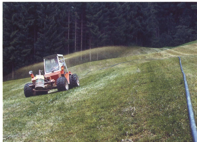
Die Gülleverschlauchung ist nicht nur hangtauglich und bodenschonend, sondern besticht bei arrondierten Verhältnissen auch durch eine hohe Ausbringleistung.
