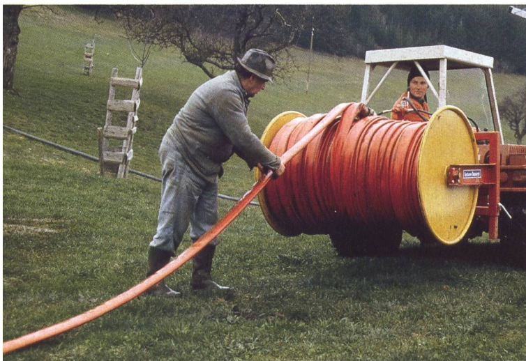
Auf einer Dreipunkthaspel lassen sich die flexiblen Schläuche platzsparend aufrollen. Die Hangtauglichkeit ist zudem ziemlich gut.
