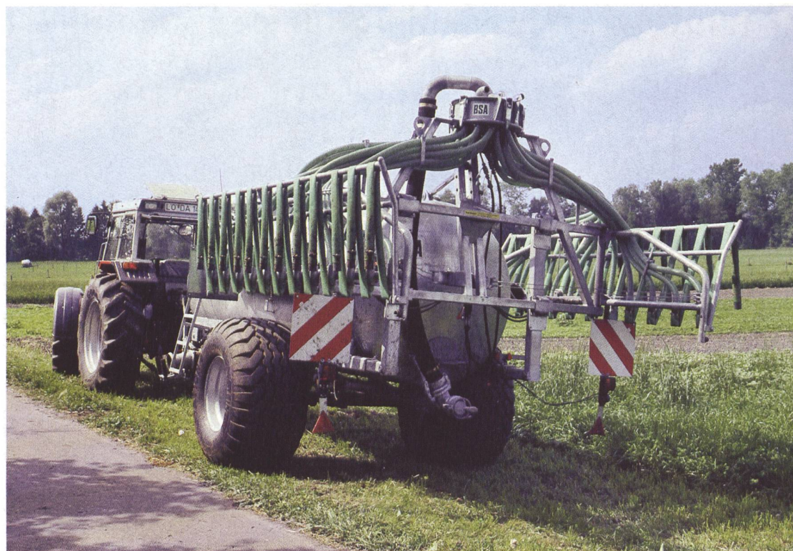
Ein Fass mit angebautem Schleppschlauchgerät ist gemäss VTS ein «Transportanhänger mit Zusatzgerät» und darf deshalb neu die zulässige Maximalbreite von 2,55 m bis zur Breite des Zugfahrzeuges überschreiten.
