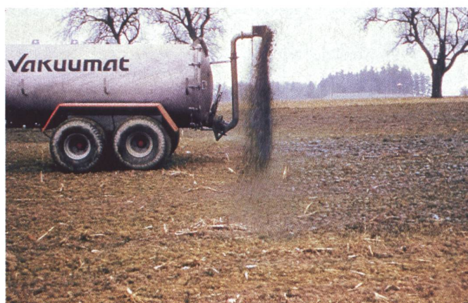
Vertikalverteiler verteilen etwas breiter als herkömmliche Prallteller und ermöglichen ein exaktes GülLEN am Anfang und Ende des Feldes.
