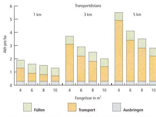
Arbeitszeitbedarf in Akhlha für die Gülleausbringung mit Vakuumfass in Abhängigkeit der Fassgrösse und der Fahrdistanz zwischen Hof und Feld. Berechnungsgrundlagen: Parzellengrösse 2 ha, Ausbringmenge 30 m³/ha. (Quelle: FAT)
