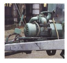
Vakuumfässer mit Kompressor überzeugen durch eine geringe Störanfälligkeit, eine lange Lebensdauer (Wartung vorausgesetzt) und die relativ günstige Anschaffung.
