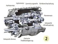
Nasse, selbstverstärkende Mehrscheibenbremse an der Allradantriebswelle (Fendt).
