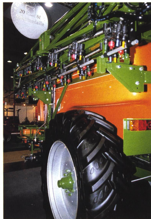
Lechler-Düsenköpfe auf Amanzone-Spritzbalken mit vier individuell zu- und abschaltbaren Düsen erlauben die teilflächenspezifische Pflanzenschutzmittelapplikation.
