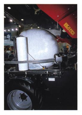
Kverneland Deutschland (Taarup) präsentierte eine Festkammer-Ballenpresse mit integriertem Wickelgerät.
