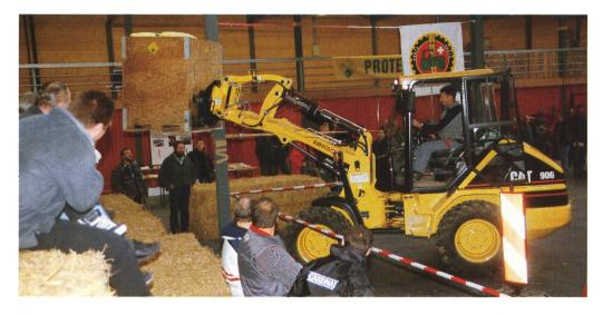
Die Baubranche als Herkunft des Hofladers ist bei diesem Pneufahrzeug unverkennbar. Die mittige Anordnung des Hebearms verbessert die freie Sicht auf das Arbeitsfeld.
