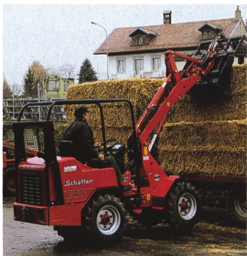
Knickgelenkte Hoflader bringen hohe Tragkraft, kleinen Wenderadius und geringe Abmessungen unter einen Hut. (Bilder: Ueli Zweifel)
