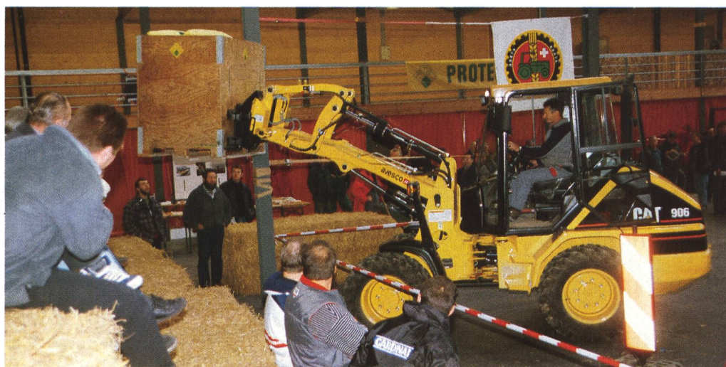
Die Baubranche als Herkunft des Hofladers ist bei diesem Pneufahrzeug unverkennbar. Die mittige Anordnung des Hebearms verbessert die freie Sicht auf das Arbeitsfeld.
