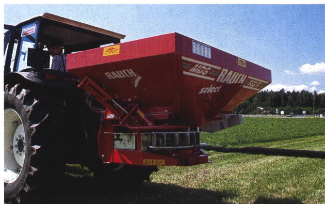
Streubegrenzungen am Feldrand sind auf vergleichsweise kleinen Parzellen doppelt wichtig: Grenzstreuen ohne Absteigen aus der Fahrgasse heraus bei dieser Maschine von Rauch. (Bild: Sepp Föhn, Maschinenberater, LS Plantahof, Landquart)
