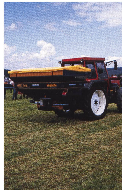
Geräte mit elektronischer Wiegeeinrichtung und automatischer Streumengenregulierung in Abhängigkeit der Geschwindigkeit. Der Mehrwert beim Komfort und bei der Streugenauigkeit wird teuer bezahlt. (Bilder: Ueli Zweifel)
