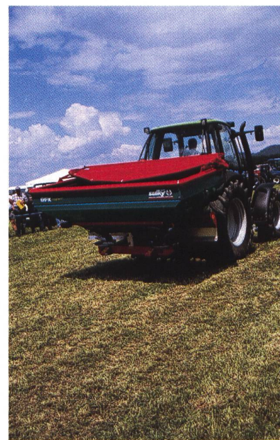
Geräte mit elektronischer Wiegeeinrichtung und automatischer Streumengenregulierung in Abhängigkeit der Geschwindigkeit. Der Mehrwert beim Komfort und bei der Streugenauigkeit wird teuer bezahlt. (Bilder: Ueli Zweifel)
