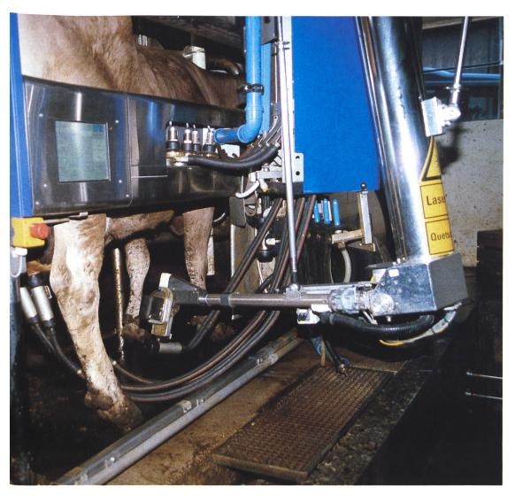
Ein riesiger Forschungsaufwand war notwendig, um zwei Schlüsselfunktionen zu automatisieren: Zitzen reinigen und Melkaggregat ansetzen. Dieses Ziel ist erreicht und der Melkroboter kommerziell verfügbare Technologie. An der Perfektionierung aber wird weiter gefeilt.
