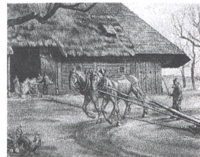
Dreschtag um 1900: Eine Dreschmaschine wird mit dem Pferdegöpel angetrieben. In ähnlicher Form fand der Göpel auch in Bergwerken Verwendung.
