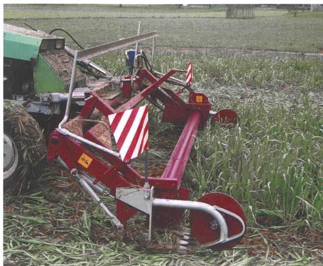
Der neue Mähaufbereiter zeichnet sich durch seine einfache und leichte Bauweise aus und lässt sich einfach an die Front montieren.
