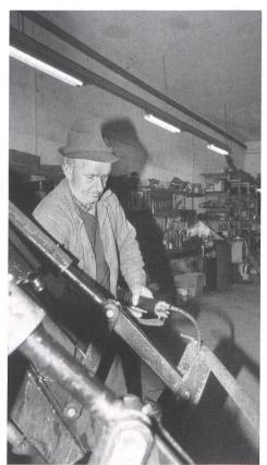
Unerlässlich auf jedem Betrieb: Servicearbeiten wie Reinigung, Ölwechsel und Schmierung.
