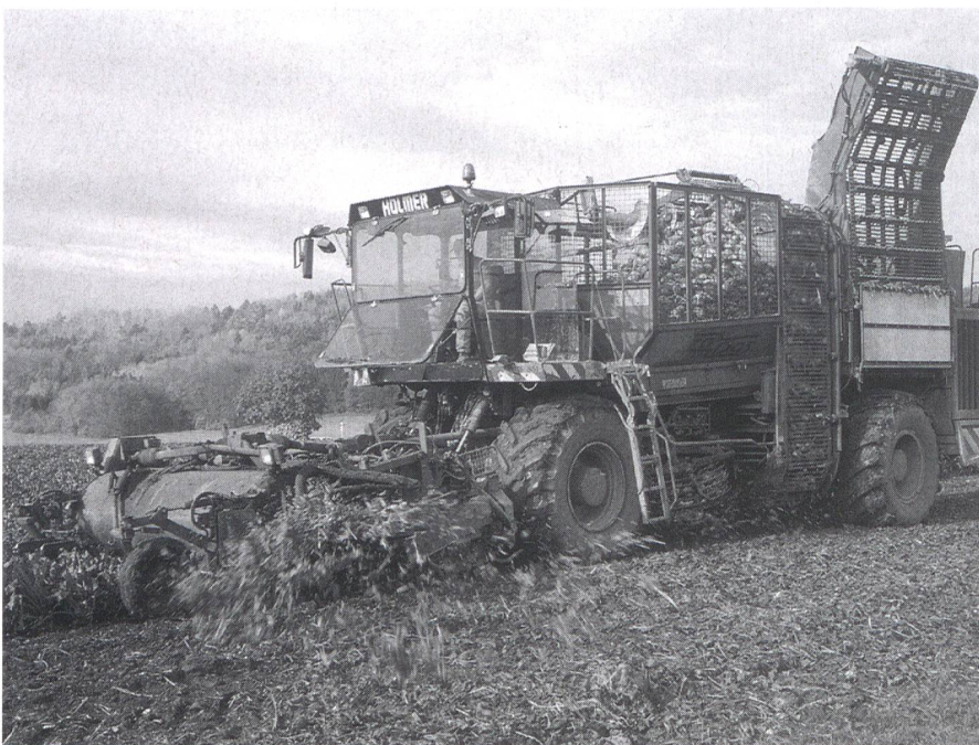
Abb. 1: Erntemaschinen mit 30–60 t Gesamtgewicht sollten nicht auf nassen Rübenböden eingesetzt werden. Dieser Vorsatz kann leider wegen des Wetterrisikos nicht jedes Jahr konsequent eingehalten werden.
