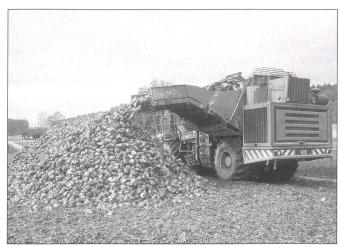
Abb. 6: Abbunkern nach jeder Runde erfordert für eine 2 ha-Parzelle nur zirka 7 min mehr als bei optimaler Bunkerauslastung.
