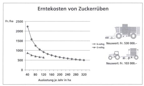
Abb. 8. Verfahrensvergleich 2-reihiger, gezogener Zuckerrübenvollernter und 6-reihiger, selbstfahrender Zuckerrübenvollernter.
