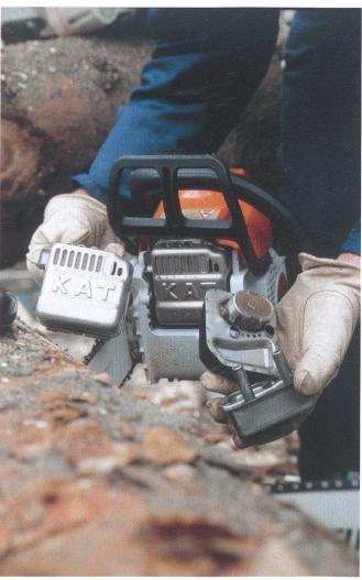
Der Zweitakt-Abgaskatalysator ist als Zusatzmodul auf allen Kettensägen und auch auf tragbaren Spritzgeräten und für Freischneider verfügbar. Er vermag den Schadstoffausstoss, der durch unverbrannte Rückstände des Zweitaktgemischs entsteht, um bis zu 60 % zu reduzieren.
