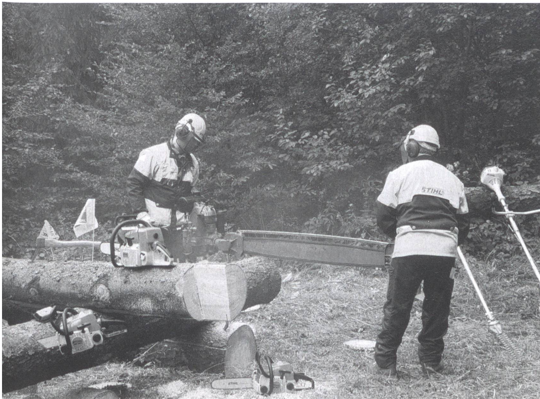
1929 brachte Andreas Stihl die «Baumfällmaschine» auf den Markt. Mit seinen 46 Kilogramm kontrastiert der Zweihänder wirkungsvoll mit den modernen Motorsägen für die professionelle Waldarbeit bzw. den Hobbybereich. Die Maschine mit der Typenbezeichnung 026 C wiegt 4,8 kg und liefert 2,6 kW Leistung.
