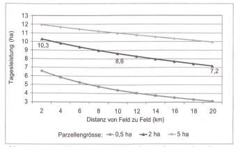
Abb. 1: Längere Anfahrtswege vermindern die Tagesleistung der schlagkräftigen Erntemaschinen ganz erheblich (Beispiel für sechsreihigen Vollernter an einem 15-Stunden-Arbeitstag).
