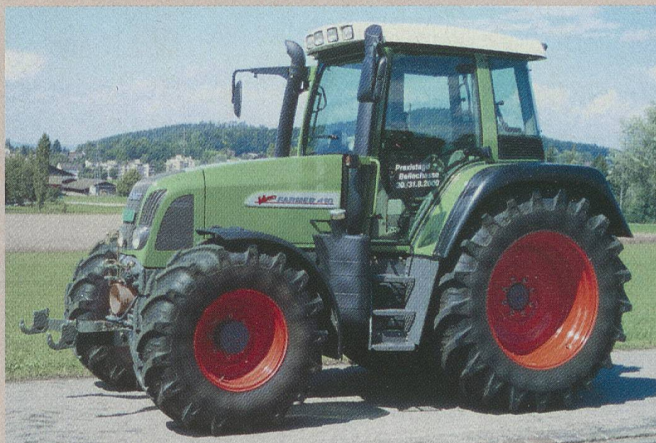
Traktor FENDT Farmer 410 Vario, 4-Zylinder-Turbomotor mit 4-Ventiltechnik und Ladeluftkühlung, 74 kW (100 PS), stufenloses Fahrgetriebe mit zwei Fahrbereichen, Fronthydraulik und Frontzapfwelle, Vorderachsfederung, Kabinenfederung, Gewicht 5420 kg, (Listenpreis Fr. 142 098.-), Traktortest-Nr. 1814/00.
