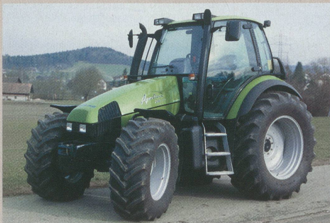
Traktor DEUTZ-FAHR Agrotion 135 MK3, 6-Zylinder-Turbomotor, 99 kW (135 PS), 4-Stufen-Lastschaltgetriebe, Vorderachsfederung, Kabinenfederung, Gewicht 6160 kg, (Listenpreis Fr. 132 950.-), Traktortest-Nr. 1822/01.
