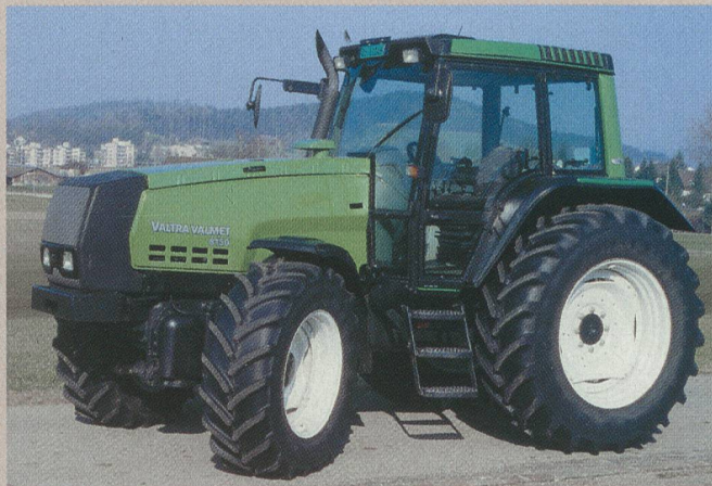
Traktor VALTRA VALMET 8150-4 HiTech, 6-Zylinder-Turbomotor, 92 kW (125 PS), 3-Stufen-Lastschaltgetriebe, Vorderachsfederung, Gewicht 5590 kg, (Listenpreis Fr. 117 850.-), Traktortest-Nr. 1817/01.
