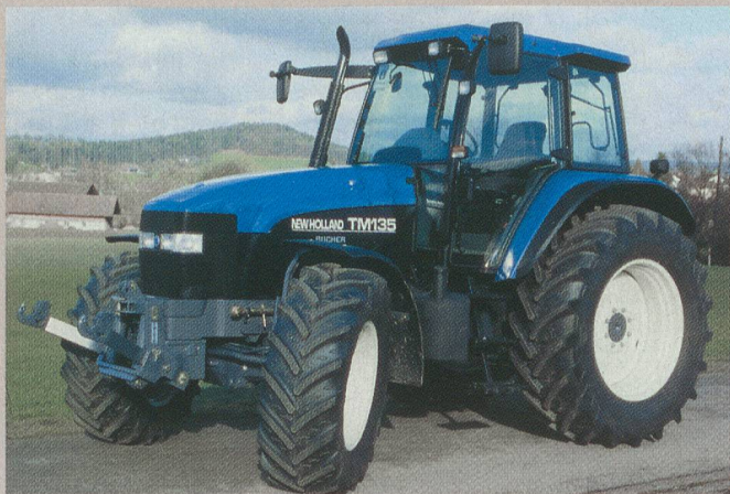
Traktor NEW HOLLAND TM135, 6-Zylinder-Turbomotor mit 93 kW (125 PS), 6-Stufen-Lastschaltgetriebe, 3 Gruppen, Fronthydraulik, Vorderachsfederung, Kabinenfederung, Gewicht 6340 kg, (Listenpreis Fr. 123 603.-), Traktortest-Nr. 1824/01.
