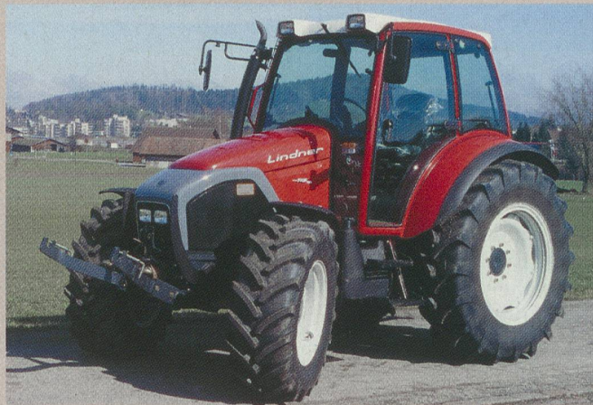
Traktor LINDNER Geotrac 100, 4-Zylinder-Turbomotor mit 72 kW (98 PS), 2-Stufen-Lastschaltgetriebe, Fronthydraulik und Frontzapfwelle, Gewicht 4070 kg, (Listenpreis Fr. 86 260.-), Traktortest-Nr. 1827/01.
