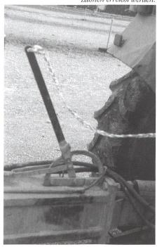
Bei landwirtschaftlichen Fahrzeugen besteht ein direkter Zusammenhang zwischen Feststell- und Betriebsbremse. Nicht nachgestellte Feststellbremsen sind häufig ein Zeichen von vernachlässigter Wartung der gesamten Bremsanlage. Anstehende Bremshebel oder komplett ausgefahrene Bremszylinder erzeugen selbst bei modernsten Bremsanlagen keine Bremswirkung.
