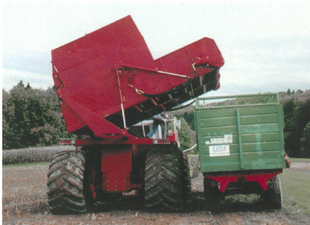
Überladen aus dem angehobenen Bunker. Der vordere und der hintere Kratzboden funktionieren separat.
