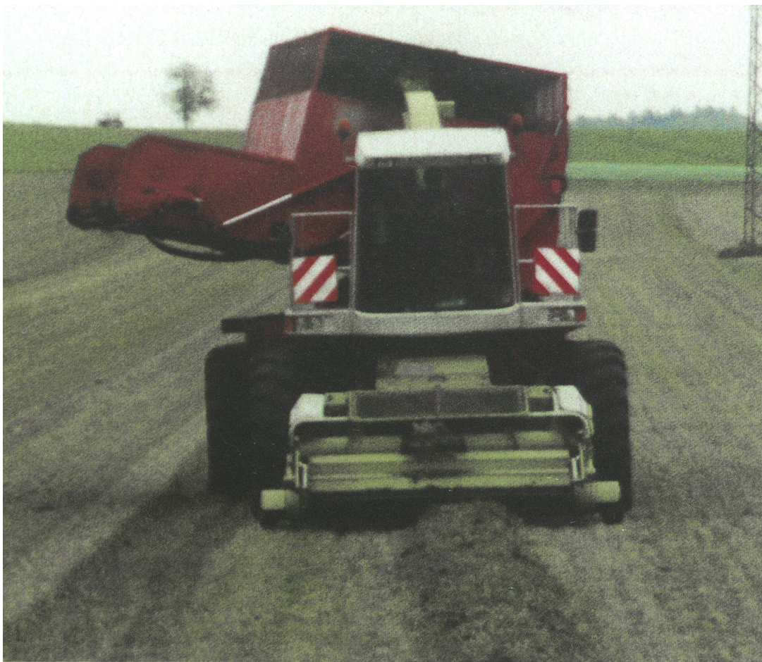
Senkung des spezifischen Bodendrucks durch Breitereifung und parallele Achsverschiebung.
