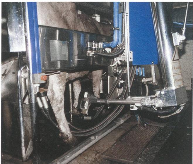
Nach der Reinigung mittels separatem Zitzenbecher (rechts erkennbar) führt der lasergeführte Melkarm, an dessen Ende eine Kamera montiert ist, die Zitzenbecher einzeln zu den Zitzen. Die Becher werden in Abhängigkeit des versiegenden Milchflusses auch wieder einzeln abgezogen. Jede Zitze wird über einen feinen Flüssigkeitsstrahl aus der Düse am Melkarm desinfiziert, der während des Melkvorgangs die Schlauchleitungen wie mit einer offenen Hand unterstützend mitträgt.
