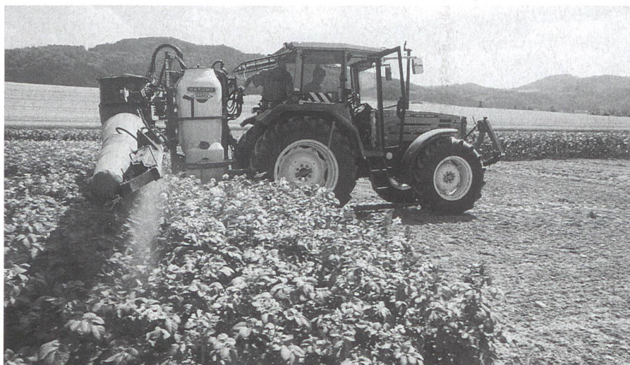
Abb. 2: Eine Luftunterstützung verbessert die Bestandesdurchdringung und reduziert die Abdrift.
