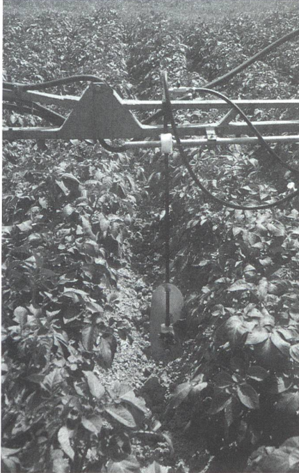
Abb. 7: Die relativ weichen Kunststoff-Rohrleitungs-Träger sind verstellbar und fixierbar (Birchmeier, Prototyp 1). Unten: Die gut platzierten Doppeldüsen erfordern einen kompakten Schutz und stabileren Träger.
