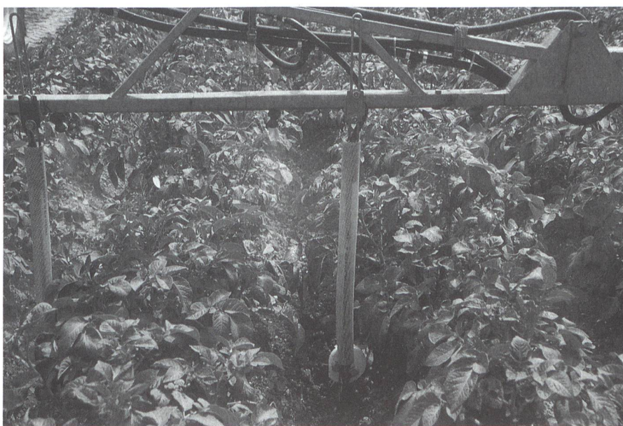
Abb. 6: Die gefederten Düsenträger sind am Spritzgestänge senkrecht und waagrecht verstellbar (Fischer, Prototyp 2). Rechts: Der trichterförmige Düsenschutz befriedigte, wird aber weiter verbessert.
