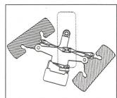
Fig. 2: Super-Steer-Achse bei den TN-Modellen von New Holland (Bild und Schema).
