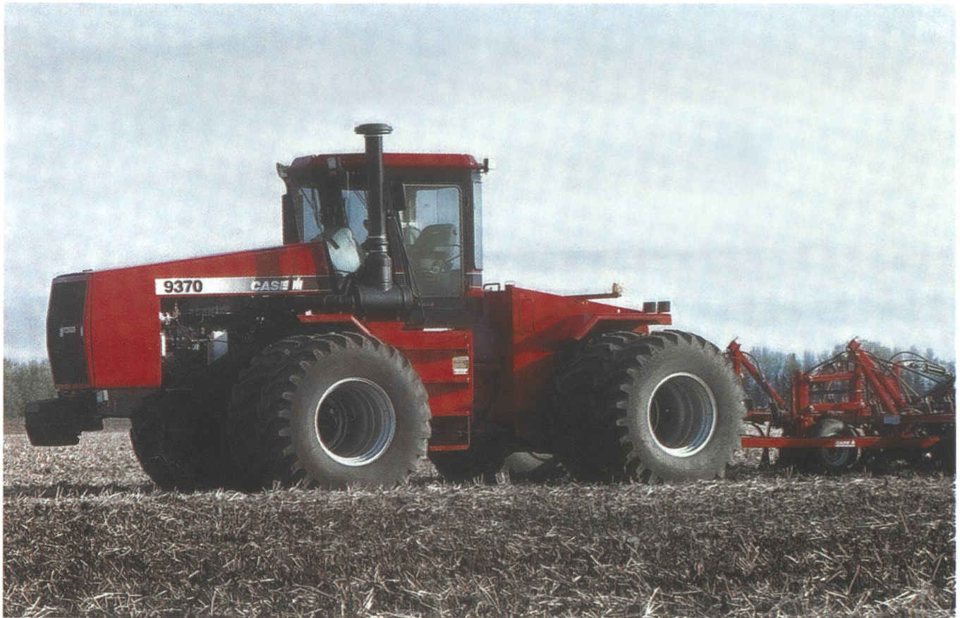
Klassischer Allrad-Zugtraktor nach amerikanischem Muster: Case IH Steiger 9370 mit 360 PS.
