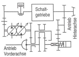
Fig. 5: Längsverteilergetriebe mit hydrostatischem Überlagerungsgetriebe für den stufenlosen Vorderachsantrieb (nach Grad).
