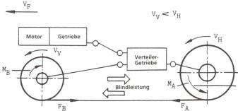
Fig. 1: Schema zur Erklärung des Entstehens der Blindleistung (Beispiel: Vorderradgeschwindigkeit V<sub>V</sub> ist kleiner als die Hinterradgeschwindigkeit V<sub>H</sub>.
