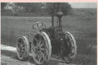
Lanz-Allrad-Knicklenker (1923). Zuschaltung der Hinterachse, abhängig vom Schlupf der Vorderräder durch einen Sperrklinkenfreilauf. (Foto: Häusler)
