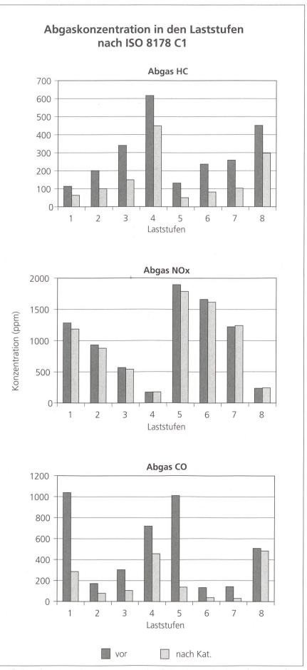
Abb. 4: Abgaskonzentration gemessen vor/nach Katalysator in den acht Laststufen.
