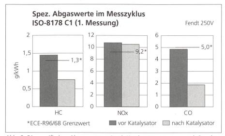
Abb. 6: Die spezifischen Abgaswerte vor/nach Katalysator gemessen nach Regelung ISO-8178 C1.
