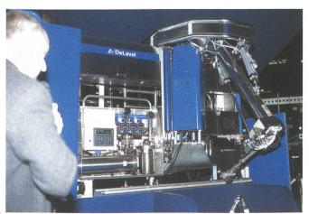
DeLaval ist bei der Entwicklung des Melkroboters eigene Wege gegangen, wie der hochentwickelte Lenkarm mit den Melkaggregaten zeigt.
