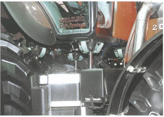
Spektakulär: Über doppelt wirkende Hydraulikzylinder wird die Traktorkabine bis zu einer Schräglage von 25 % waagrecht gebalten.
