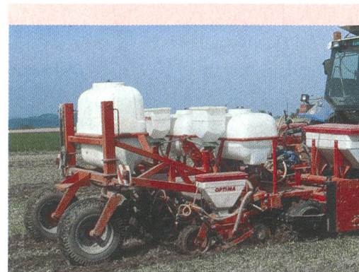
Abb. 2: Die Streifenfrässaat gilt als bewährter Kompromiss zwischen der ganzflächigen Lockerung und der Direktsaat.
