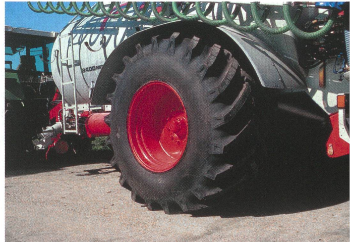
Spezielle Radkästen mit Fasseinbuchtung, wie sie bereits mehrere Fasshersteller anbieten, ermöglichen das Montieren von Breitreifen, ohne die maximal erlaubte Gesamtbreite nach Strassenverkehrsgesetz zu überschreiten.
