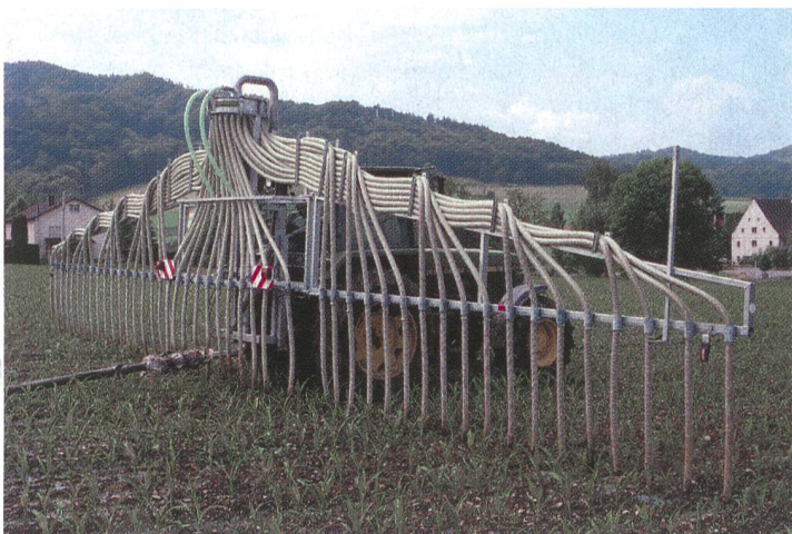
Schleppschlauchverteiler am Heckhubwerk des Traktors ermöglichen eine bodenschonende Düngung mit exakter Querverteilung und geringen Stickstoffverlusten.
