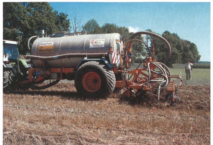
Mit einem am Fass angebauten Tiefinjektor (4,5 m Arbeitsbreite) lassen sich die Stoppelbearbeitung und die Gülledüngung für die Folgekultur im gleichen Arbeitsgang erledigen. Wegen des hohen Zugkraftbedarfes (erforderliche Traktorstärke von 130 kW und mehr) muss der Boden gut abgetrocknet sein, ansonsten starke Schlupf- und Bodenschäden entstehen.
