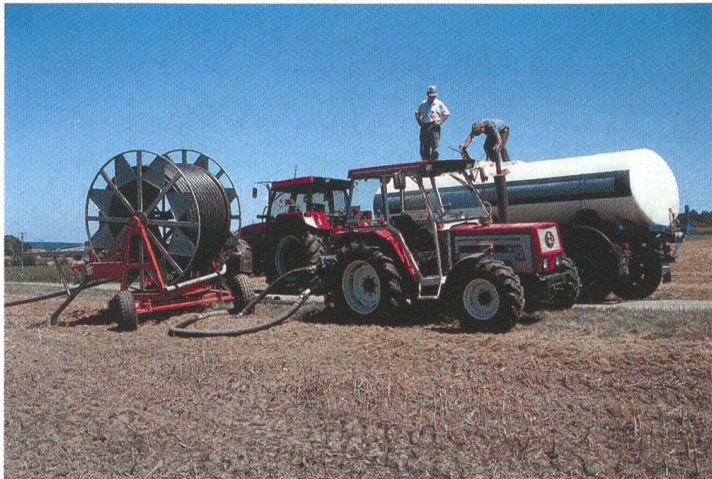
Verschlauchungsverfahren sind äusserst bodenschonend und erzielen hohe Ausbringleistungen. Der Aufwand an Traktoren, Maschinen und Personal ist jedoch beträchtlich, wenn am Feldrand ein Zwischenlager eingerichtet werden muss.
