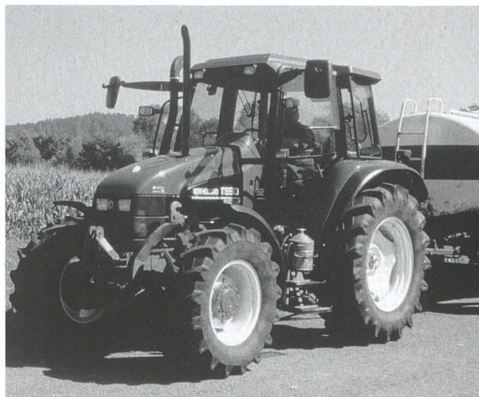
Der Vergleichstraktor New Holland TS 90 Turbo. Die vier Lastschaltstufen können mit einer einzigen Kupplungsbedätigung zweimal durchgeschaltet werden. Die Strassengruppe deckt somit ein Geschwindigkeitsbereich von 9,9 bis 39,8 km/h ab.
