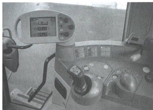
A1 Fendt 410 Vario: die Fahrstrategie «hohe Leistung» oder «treibstoffsparend» lassen am übersichtlichen Fahrterminal einstellen.
