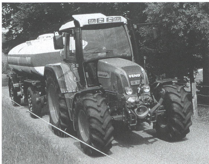
Die Fabrtests auf drei verschiedenen Fahrstrecken mit zwei unterschiedlichen Anhängelasten ergeben interessante Vergleichsergebnisse in Bezug auf Fahrgeschwindigkeit und Treibstoffverbrauch. (Fendt 410 Vario: siehe auch Traktortest Seite 16.)
