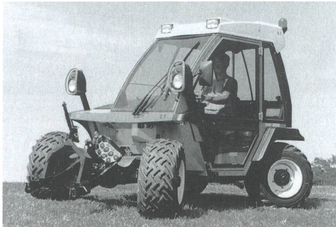
Metrac H7: Allradlenkung auf Knopfdruck auf Front-, Heck- und Hundeganglenkung umschaltbar.
