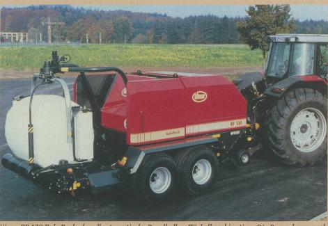
Vicon RF 130 Bale Pack als vollautomatische Rundballen-Wickelkombination. Die Presse kann auch ohne das Wickelgerät eingesetzt werden.
