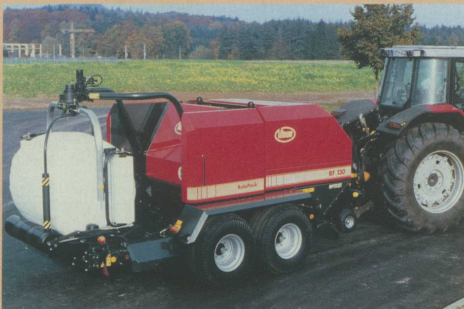
Vicor RF 130 Bale Pack als vollautomatische Rundballen-Wickelkombination. Die Presse kann auch ohne das Wickelgerät eingesetzt werden.
