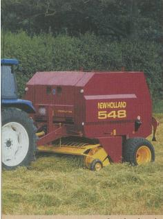
erpresse 548 mit Crop-Cutter-Schneidwerk und der Arbeitsfunktionen.
