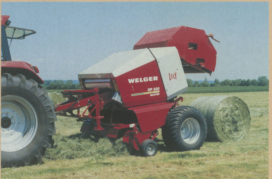
Innovatives Design im Äusseren. Variables Presssystem bis 4-m 3 -Ballen im Innern.
