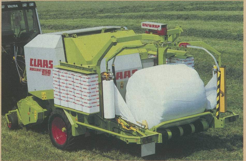
Der Erntespezialist CLAAS kommt zur neuen Saison mit einer Kombination der Rollant-Rundballenpresse mit dem Uniwrap-Wickler.
