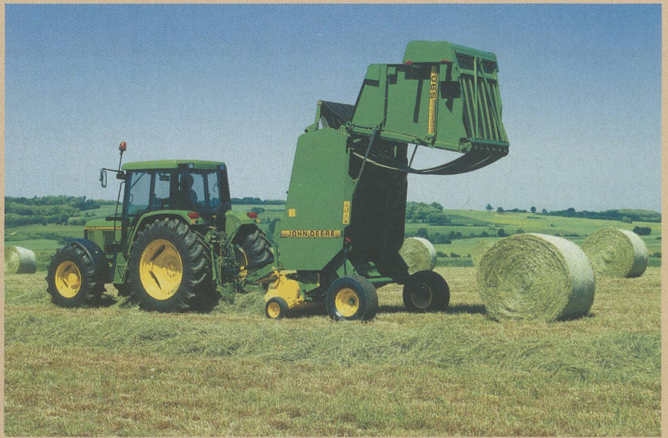
Die Vario-Kammerpresse 590 von John Deere ist jetzt mit 2-m-Pick-up und 14-Messer-Schneidwerk auf dem Markt.
