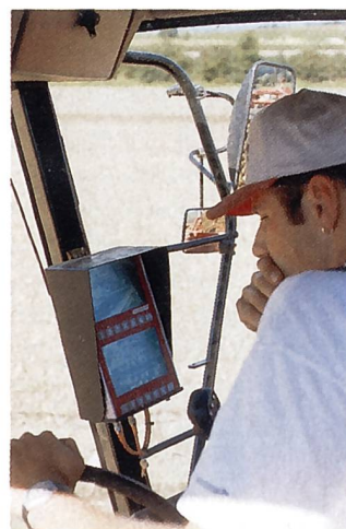
Blick in die von Claas gelieferte Fabrikkabine, die um 25° schwenkbar und seitlich auch verschiebbar ist. Auf dem Grimme-Selbstfabrer SF 150-60 gehört die Videoüberwachung mit vier Kameras serienmässig zum Lieferumfang.
