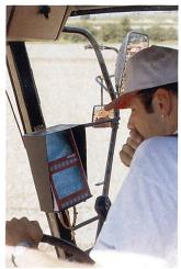
Blick in die von Claas gelieferte Fahrerkabine, die um 25° schwenkbar und seitlich auch verschiebbar ist. Auf dem Grimme-Selbstfahrer SF 150-60 gebört die Videoüberwachung mit vier Kameras serienmässig zum Lieferumfang.
