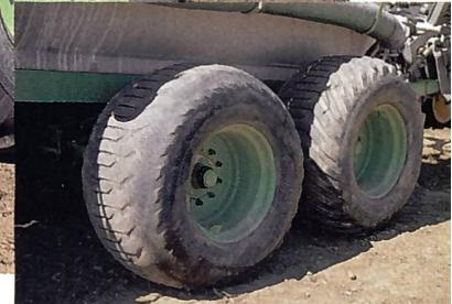
Bei einer Tandemachse aber erweist es sich als sehr wünschbar, wenn eine Achse gelenkt oder als Nachlaufachse funktioniert, damit die Reifenabnutzung limitiert werden kann.
