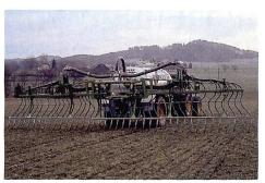
Schleppschlauchsystem mit 12 m Arbeitsbreite. Dieses verursacht inklusive Aufbau an einem Druckfass Investitionen von rund Fr. 16 000.— und umgerechnet auf den Kubikmeter ausgebrachte Gülle eine Verteuerung von Fr. 2.—/m³.
