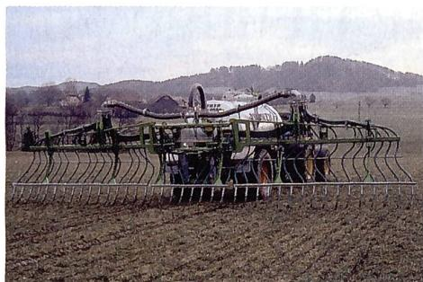
**Schleppschlauchsystem mit 12 m Arbeitsbreite.**
