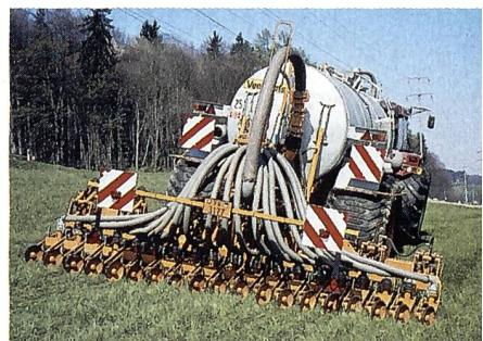
**Gülleeindrillsystem in der Regel mit 10 bis 24 Scheibenscharen in Abständen von 20 bis 25 cm, um die Gülle in 4 bis 10 cm Bodentiefe zu deponieren.**
