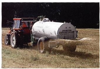
4000-l-Druckfass mit Güllezufuhr von oben auf den Prallteller. Es ist wichtig, die Verteilung genau einzuregulieren und bei den Anschlussfahrten eine optimale Linie einzuhalten. Werden pro Jahr 2000 m³ Gülle ausgebracht, belaufen sich die Kosten mit Zugfahrzeug auf Fr. 5.25 pro Kubikmeter.
