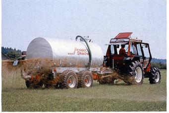
8000-l-Druckfass mit Verteilkopf und Tandemachse. Dieses Verteilsystem hat den Vorteil vor allem auch an den Parzellengrenzen, d.h. am Anfang und am Ende präziser zu arbeiten. Werden pro Jahr 4000 m³ Gülle ausgebracht, belaufen sich die Kosten mit Zugfahrzeug auf Fr. 4.18 pro Kubikmeter.
