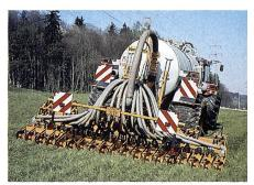
Gülleeindrillsystem in der Regel mit 10 bis 24 Scheibenscharen in Abständen von 20 bis 25 cm, um die Gülle in 4 bis 10 cm Bodentiefe zu deponieren.
