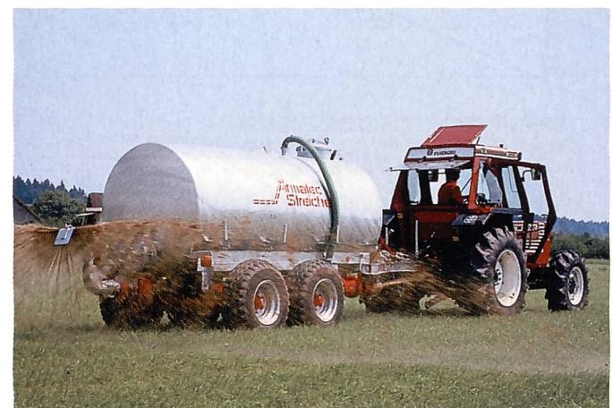
8000-l-Druckfass mit Verteilkopf und Tandemachse.
