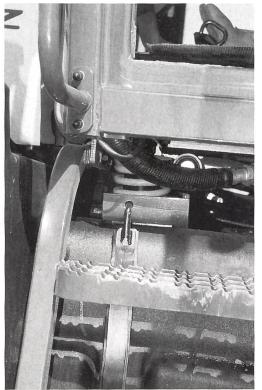
Alle Z-Modelle sind mit der «hydrostabilen» Kabine (Hydrostable®) ausgeriistet.
