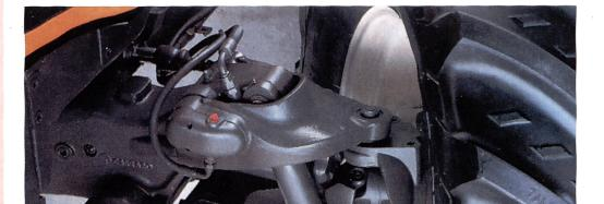
Als Option kann bei der ARES-Baureihe die gefederte Vorderachse PROACTIV eingebaut werden (Firmenbild).
