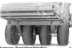
Kurmann-Doppelpendelachse 4-fach Bereifung 19x17" 10 Tonnen Tragkraft Hydraulische 4-Rad-Bremse
