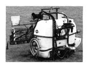
den Profilrohrrahmen integriert, dadurch liegt der Schwerpunkt sehr nahe am Traktor. Diese kompakte Bauweise gewährleistet einen problemlosen Einsatz in Hanglagen und sicheren Strassentransport.
