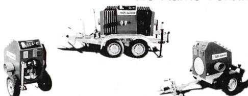
Zapfwellenleistungsbremsen von 5-450 kW, computergenau, luftgekühlt, Direktanzeigen, einfach kalibrierfähig, zukunftsorientiert. Software: Messmodus und Aufzeichnungen nach DIN 70020-Iso 3046
