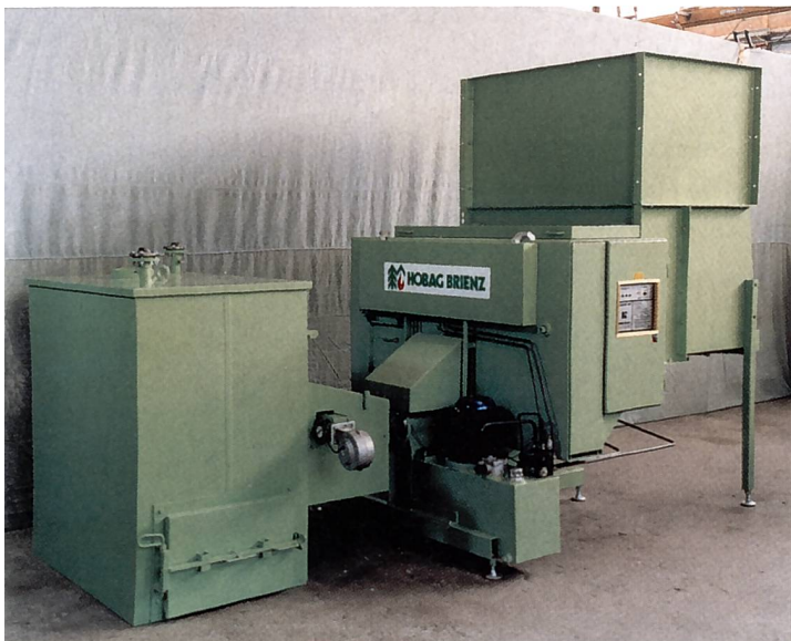
Automatische Stückholzfeuerung System Hobag (r.), Typ 21 K, Leistung bis 45 kW, mit 2-m 3 -Vorratsbehälter.
