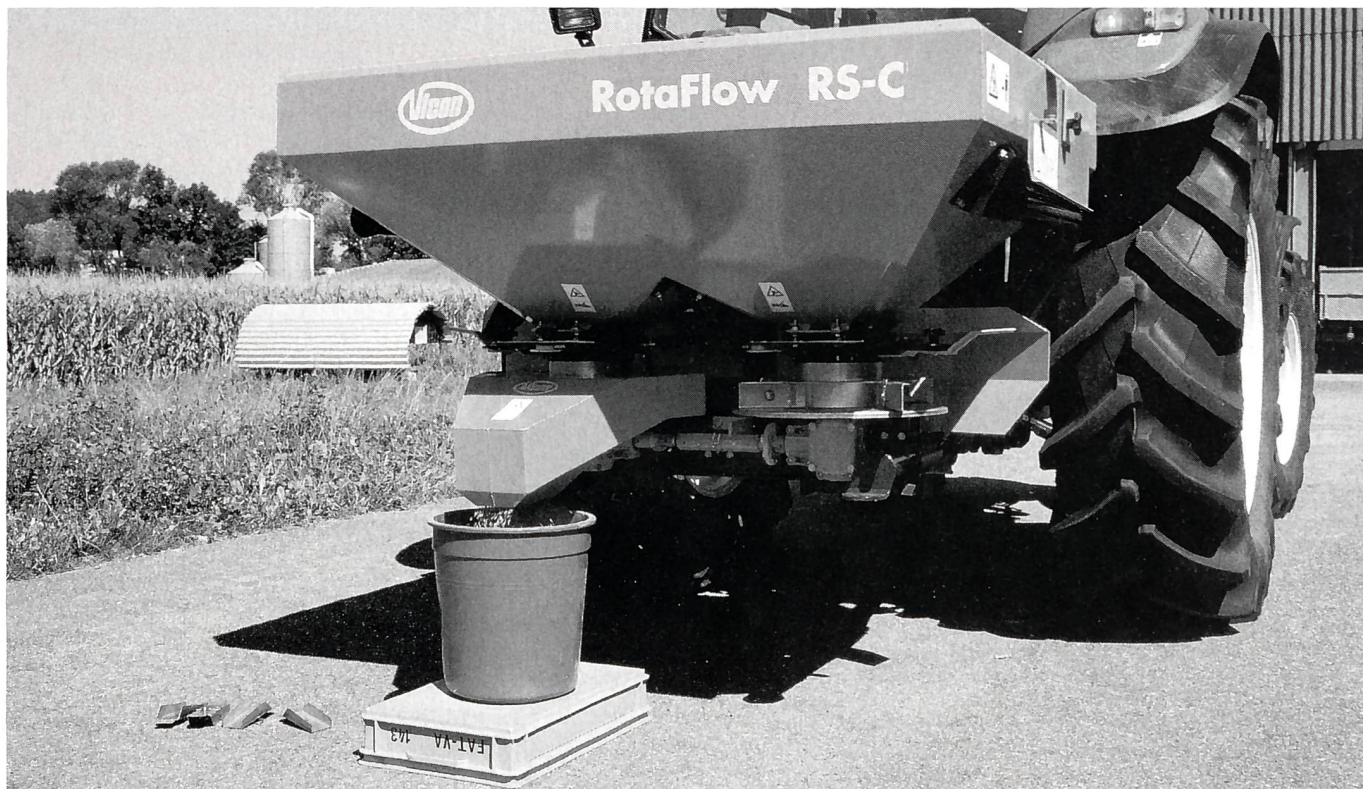
Zu einem modernen Düngerstreuer gehören eine übersichtliche Streutabelle, Grenzstreuvorrichtung und ein Abdrehschabenset, mit welchem sich die gewünschte Streumenge exakt einstellen lässt.
