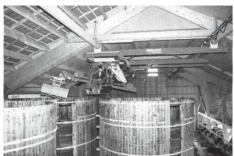
Bächtold Heukran mit Seitenfahrwerk. Die Kabine ist für eine freie Sicht in die Silos nach vorne versetzt.
