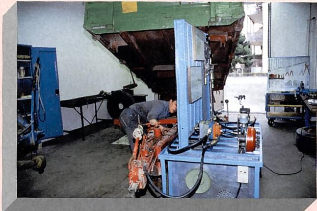
Mit grossem Erfolg werden hydraulische Bremsanlagen auf Anhängern in einem zweitägigen Kurs am Weiterbildungszentrum in Riniken nicht nur montiert, sondern nachher auch vorschriftsgemäss auf den festgelegten Druck eingestellt und geprüft.
