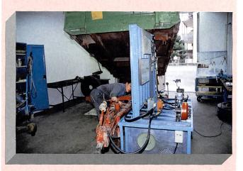
Mit grossem Erfolg werden hydraulische Bremsanlagen auf Anhängern in einem zweitägigen Kurs am Weiterbildungszentrum in Riniken nicht nur montiert, sondern nachher auch vorschriftsgemäss auf den festgelegten Druck eingestellt und geprüft.
