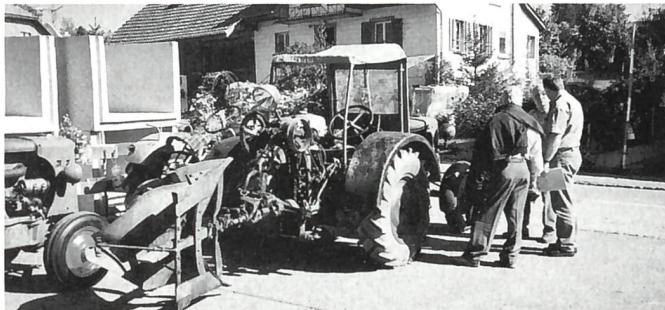
Ein rares Stück: Ein Hürlimann Typ 4 DT 47 von 1944 mit Hürlimann-Dieselmotor, Lizenz Saurer, und Elektro-Pflug Schmid. Das Fahrzeug wurde aus Luxemburg in die Schweiz zurückgebracht. Nach dem Krieg kam die Maschine in einer sog. Ackerbaukolonne in den Einsatz. Damit half die Schweiz 1945/46 beim Wiederaufbau der zerstörten Ländereien in Frankreich, Luxemburg und Italien.
