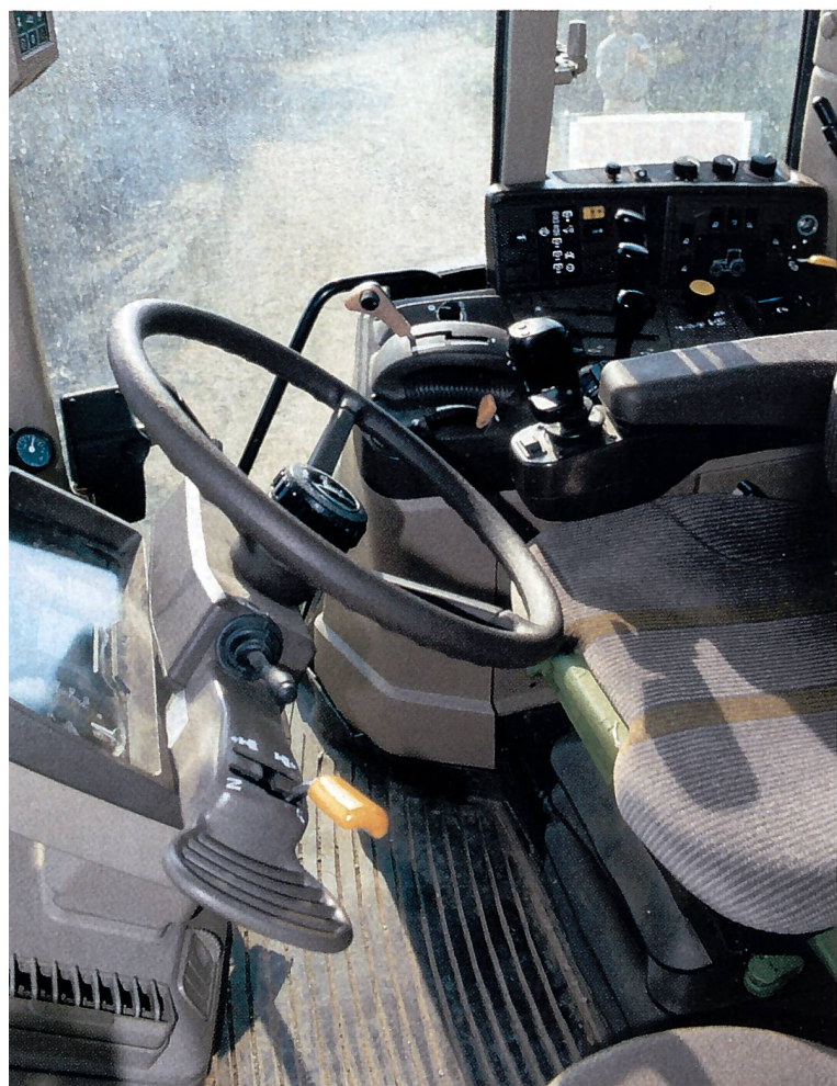
John Deere setzt auf Kontinuität: Die AutoPowr-Fabrerkabine hat wenig Änderungen erfahren. Erkennbar sind aber die beiden neuen Hauptbedienelemente Powr-Reverser mit Stillstandregelung vorne und Geschwindigkeitsregler mit Drehknopf für die Soll-Geschwindigkeitsveränderung hinten. Dabinter ist auch der Drehknopf für den Fahrmodus erkennbar.
