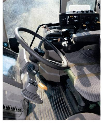
John Deere setzt auf Kontinuität: Die AutoPowr-Fahrerkabine bat wenig Änderungen erfahren. Erkennbar sind aber die beiden neuen Hauptbedienelemente Powr-Reverser mit Stillstandregelung vorne und Geschwindigkeitsregler mit Drebknopf für die Soll-Geschwindigkeitsveränderung binten. Dabinter ist auch der Drebknopf für den Fahrmodus erkennbar.
