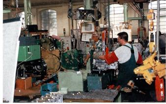
Bau der 6010-Serien in den traditionsreichen Montagehallen der John Deere Werke, Mannheim. Die vorgefertigten Baugruppen werden innerhalb von 5 Stunden zum fertigen Traktor zusammengehaut. Jeder Traktor durchläuft dabei auf dem sogenannten «Schubpallettenband» 75 Stationen.
