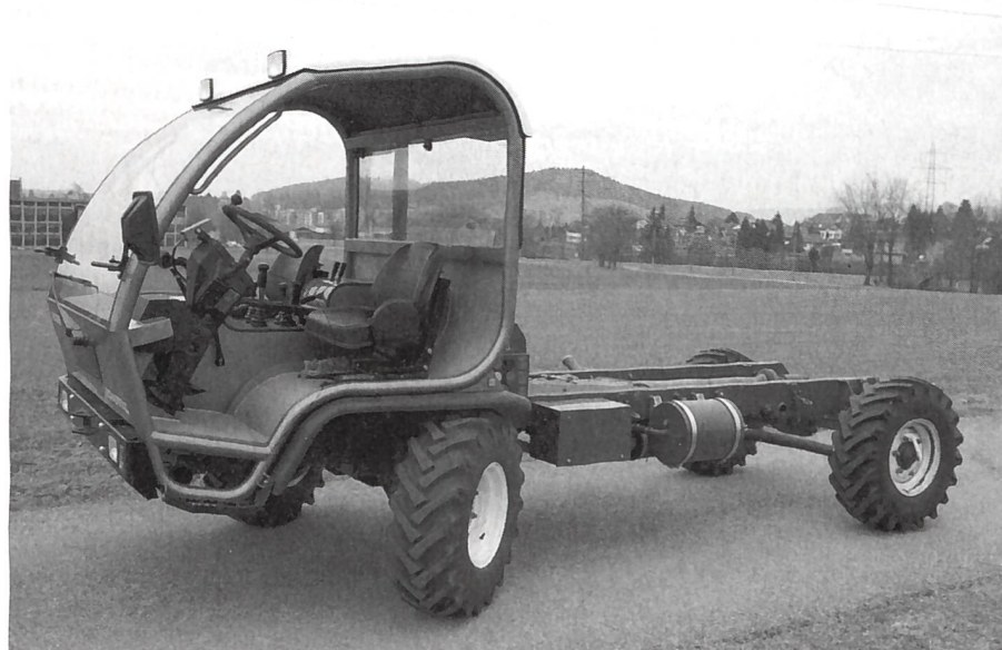
Abb. 1: Transporter SCHILTRAC 2068 (Version 40 km/h), 4-Zylinder-Turbomotor mit 61 kW (83 PS), 2-Stufen-Lastschaltgetriebe, Leergewicht 2180 kg, zulässiges Gesamtgewicht 7000 kg, (Listenpreis Fr. 78 200.-), FAT-Transportertest-Nr. 1797/00. Die Prüfverfahren der technischen Prüfung in der Schweiz und Österreich wurden angeglichen. Die Resultate sind somit grenzüberschreitend austauschbar.
