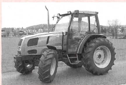
Traktor LANDINI Globus 65 Turbo, 4-Zylinder-Turbomotor mit 55 kW (75 PS), 2-Stufen-Lastschaltgetriebe, Gewicht 2920 kg, (Listenpreis Fr. 61 200.-), Traktortest-Nr. 1811/00.
