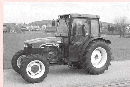
Traktor NEW HOLLAND TN 75 F, 4-Zylinder-Saugmotor mit 56 kW (76 PS), 2-Stufen-Lastschaltgetriebe, Traktorvorderachse SuperSteer, Gewicht 2810 kg, (Listenpreis Fr. 71 800.-), Traktortest-Nr. 1812/00.
