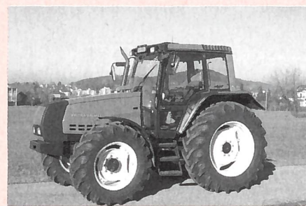
Traktor VALMET 6850-4 HiTech, 4-Zylinder-Turbomotor mit Ladeluftkühlung, 88 kW (120 PS), 3-Stufen-Lastschaltgetriebe, Gewicht 4720 kg, (Listenpreis Fr. 96 900.-), Traktortest-Nr. 1800/00.
