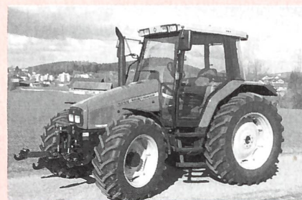
Traktor MASSEY FERGUSON 6255, 4-Zylinder-Turbomotor mit 70 kW (95 PS), 4-Stufen-Lastschaltgetriebe, Fronthydraulik und Frontzapfwelle, Gewicht 4870 kg, (Listenpreis Fr. 106 425.-), Traktortest-Nr. 1803/00.
