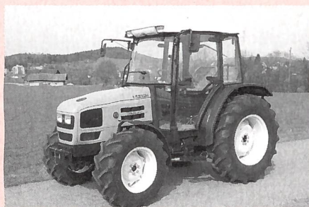
Traktor HÜRLIMANN XA 656, 3-Zylinder-Turbomotor mit 46 kW (63 PS), 3-Stufen-Lastschaltgetriebe, Gewicht 2830 kg, (Listenpreis Fr. 61 200.-), Traktortest-Nr. 1809/00.
