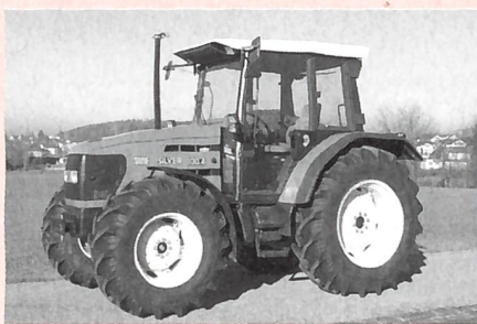
Traktor SAME Silver 100.4, 4-Zylinder-Turbomotor mit Ladeluftkühlung, 74 kW (100 PS), 3-Stufen-Lastschaltgetriebe, Gewicht 4250 kg, (Listenpreis Fr. 86 100.-), Traktortest-Nr. 1799/00.
