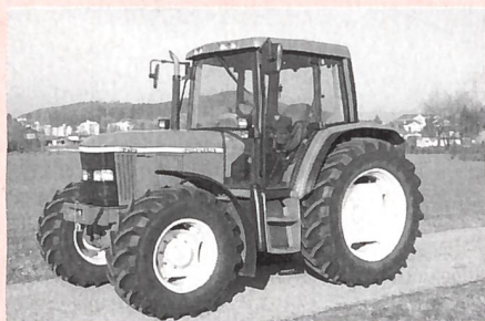
Traktor JOHN DEERE 6310, 4-Zylinder-Turbomotor mit 74 kW (100 PS), 4-Stufen-Lastschaltgetriebe, Vorderachsfederung, Gewicht 4920 kg, (Listenpreis Fr. 102 685.-), Traktortest-Nr. 1801/00.
