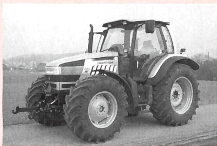
Traktor LAMBORGHINI Champion 135, 6-Zylinder-Turbomotor mit 3-Ventiltechnik, 99 kW (135 PS), Getriebe mit 18 Lastschaltstufen in zwei Gruppen, Fronthydraulik und Frontzapfwelle, Gewicht 7200 kg, (Listenpreis 137 900.-), Traktortest-Nr. 1798/00.
