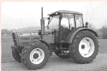
Traktor ZETOR 116 41, 6-Zylinder-Saugmotor mit 81 kW (110 PS), 3-Stufen-Lastschaltgetriebe, Gewicht 4610 kg, (Listenpreis Fr. 95 138.-), Traktortest-Nr. 1802/00.
